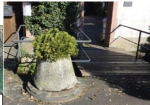
Abb. 3 Der Mahlstein einer Hanfmühle. Zwei konisch zulaufende Mahlsteine wurden waagrecht übereinander angebracht, um die Hanffasern aufzuschließen.
